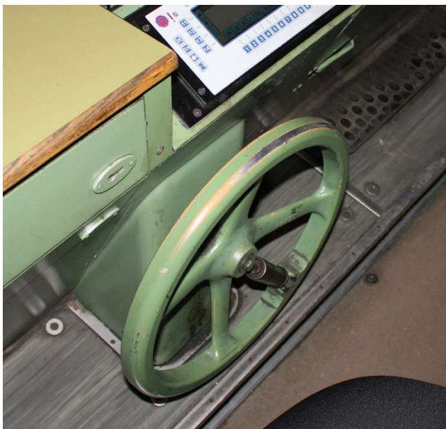
Abbildung 01: Kurbel zur Betätigung der Handbremse
