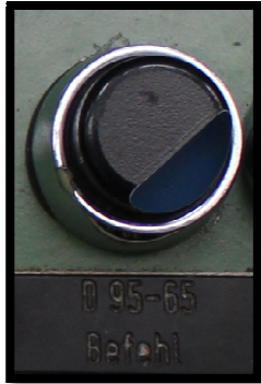
Abbildung 29: Leuchtmelder Indusi Zugart D95-65
