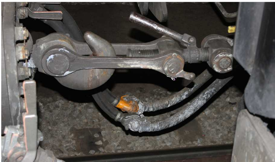
Abbildung 05: Bremsschläuche zwischen Lok und Waggon
