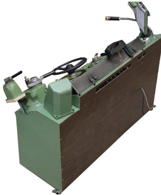
Abbildung 43: Fahr Simulator mit Abdeckplatte auf der Rückseite
