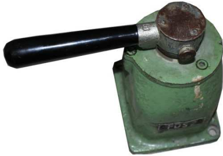
Abbildung 02: Oerlikon FDS2 Zusatzbremsventil
