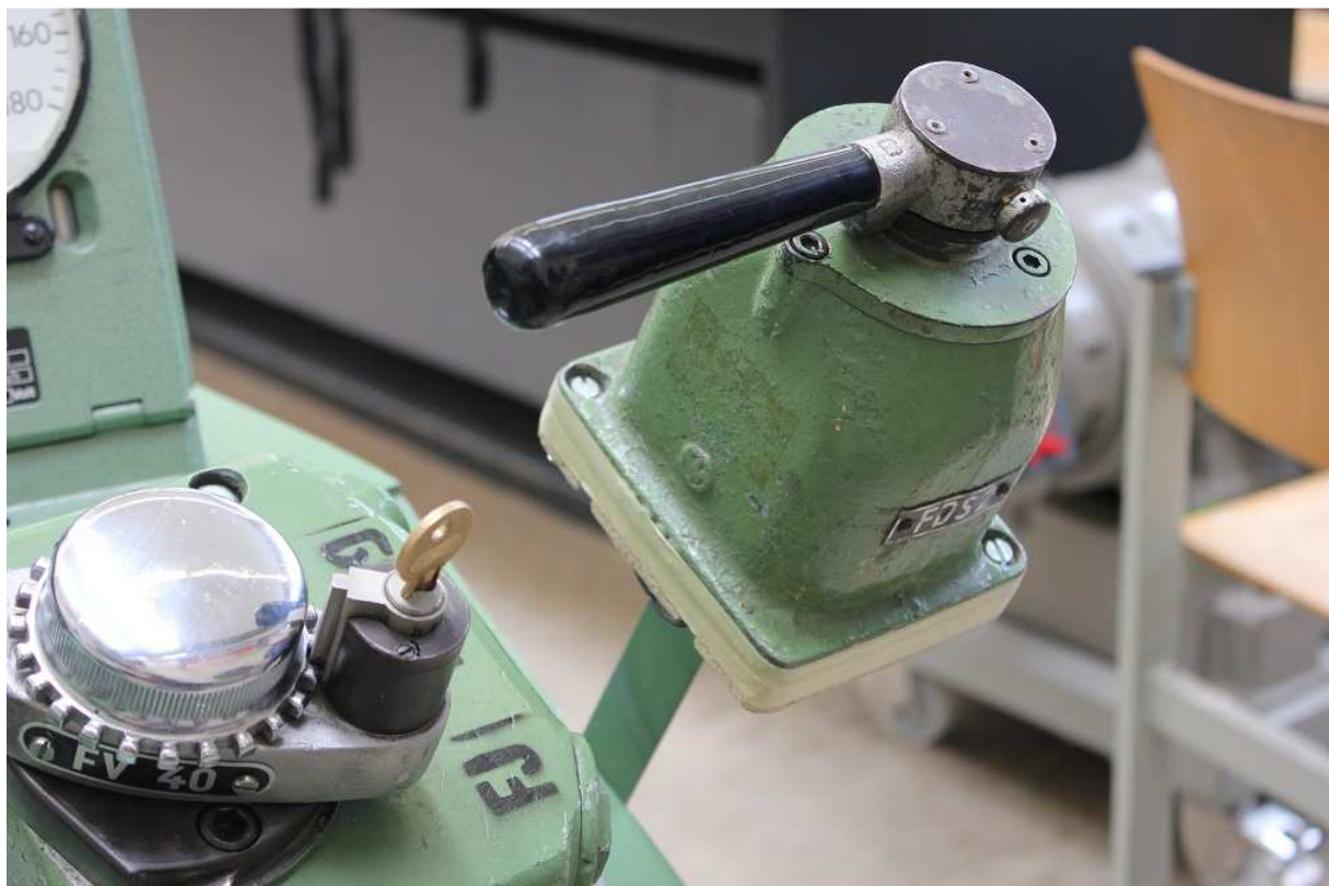
Abbildung 22: Zusatzbremsventil am Fahrsimulator
