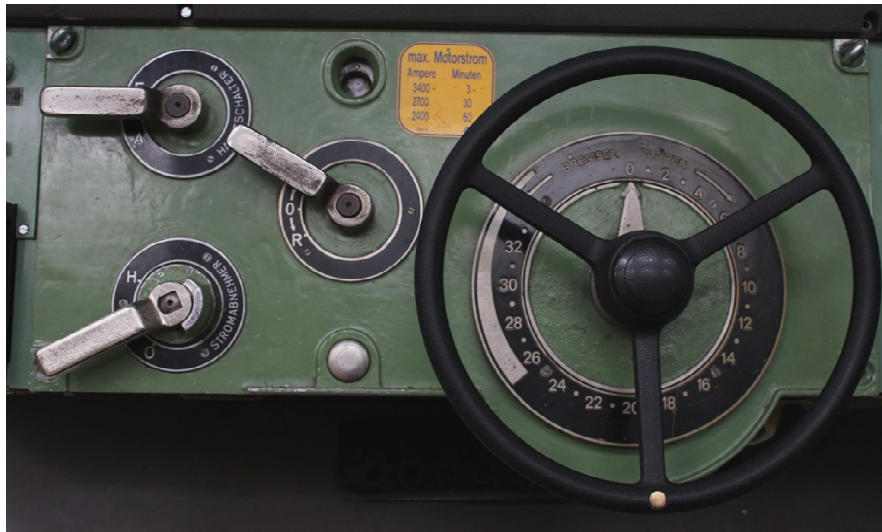
Abbildung 18: Fahrschaltereinheit mit Schaltwalzen und Stufenanzeige
