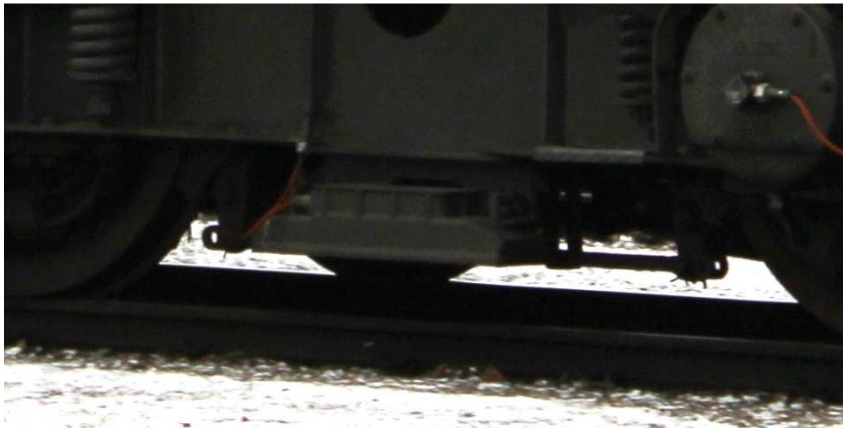
Abbildung 07: Indusi Fahrzeugmagnet an einer Lokomotive (Quelle: S. Nestinger)
