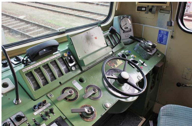
Abbildung 11: Der Führerstand einer Lok der Reihe 1142 (Quelle: bahnvideos.net)
