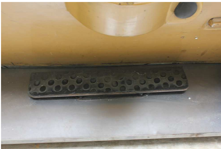
Abbildung 06: Sifa Pedal auf der Bodenplatte
