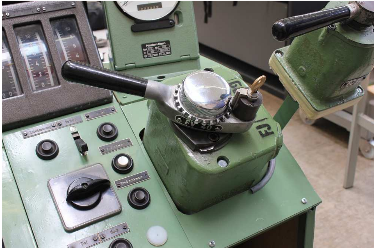
Abbildung 21: Führerbremventil am Fahr Simulator
