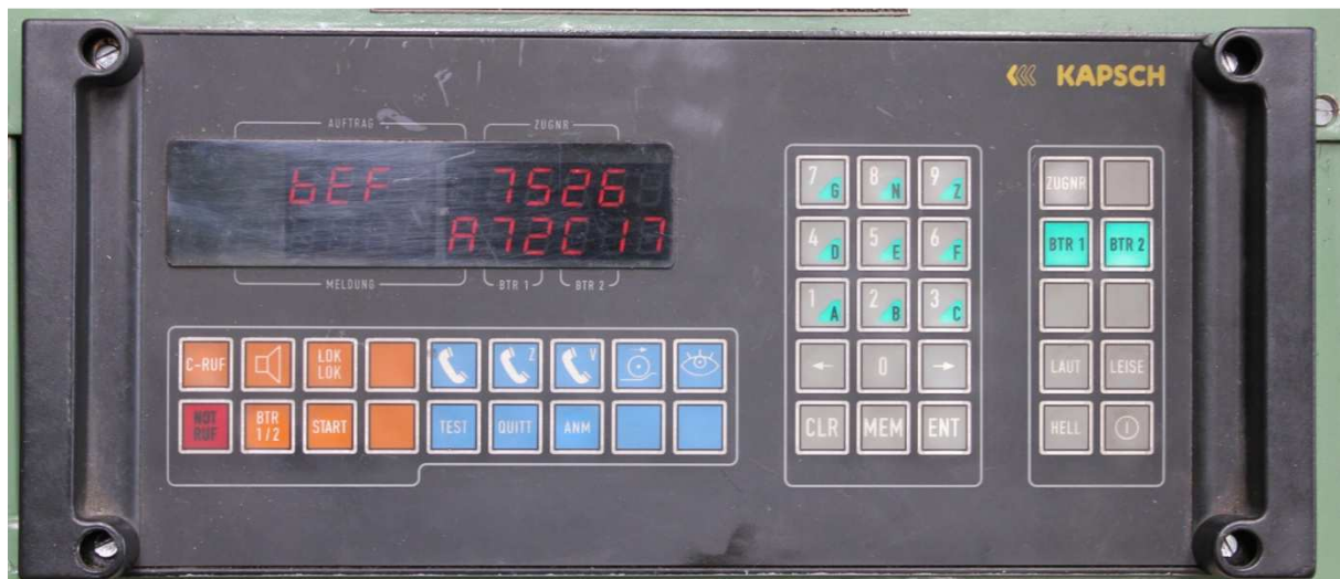
Abbildung 23: Grundbild des analogen Zugfunkgerätes ZFM 90
