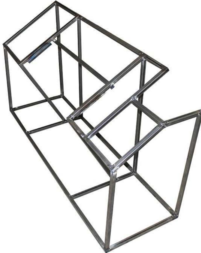
Abbildung 24: Das Stahlgerüst zu einem frühen Fertigungszeitpunkt (20.07.2012)
